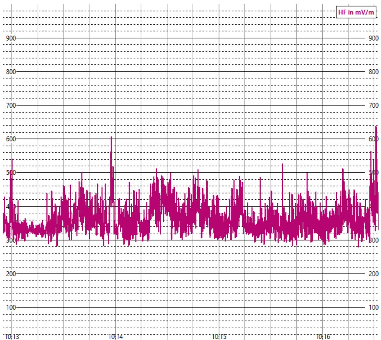
Geräte eingeschaltet: Bluetooth Verbindung Mobiltelefon, Audio Box, Lap Top mit Suchmodus WLAN Verbindung, Mobiltelefon für Telefonie, WLAN Suchmodus am Mobiltelefon, Einfluss von aussen durch Mobilfunk, WLAN vom Bürogebäude allgemein nicht verbunden mit eigenen Geräten.
